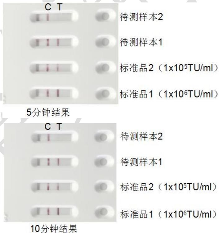
对照线“C 线”通常在 5 分钟之内显色。检测线“T 线”根据包装上清中的病毒滴度不同，在 5~10 分钟内显色。通常，病毒滴度至少在  $1 \times 10^6$  TU/mL 以上才对某些种类细胞具一定的转染效力。
